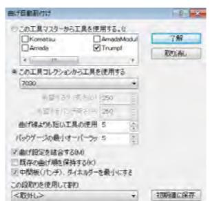
選択した加工機の保有金型から優先順位の高い順に、曲げ金型、曲げ順、金型レイアウト、曲げ寸法などの曲げに必要なデータを作成します。
