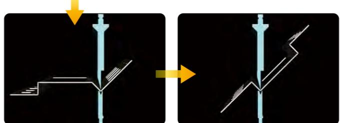
カバー関係のような深曲げ製品の干渉を回避するための二度曲げ処理を行います。
