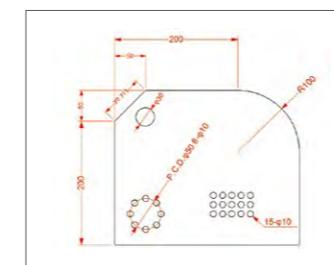
このコマンド一つで殆どの寸法線を入力できます。Ctrlキーを押しながらホイールを廻すと、文字サイズの調整が出来ます。マウスの動きによって水平・垂直・線長が切り替わります。
