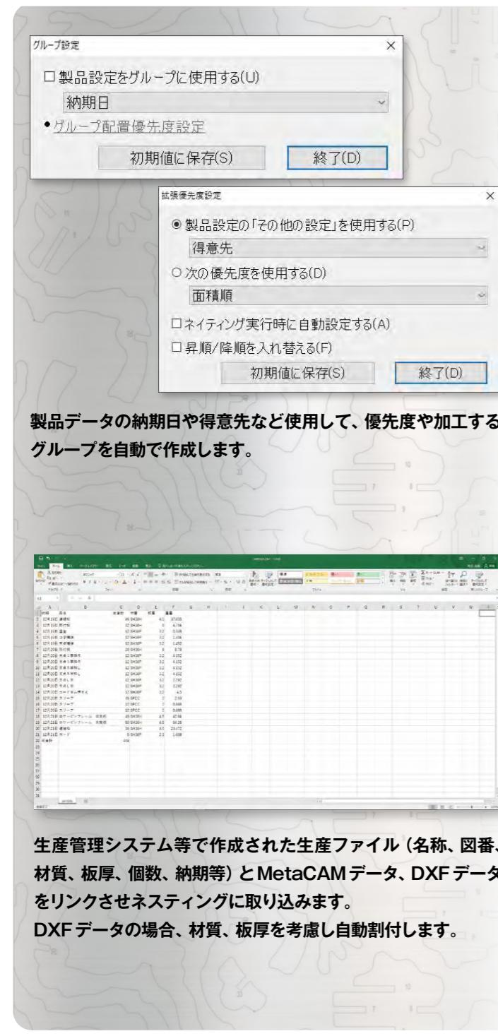
生産管理システム等で作成された生産ファイル（名称、図番、材質、板厚、個数、納期等）とMetaCAMデータ、DXFデータをリンクさせネスティングに取り込みます。
