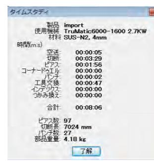
加工に要する時間（ピッキング、実加工時間、空走時間）周長、ピアス回数、製品重量を表示。加工機に合わせて帳票出力も出来ます。
